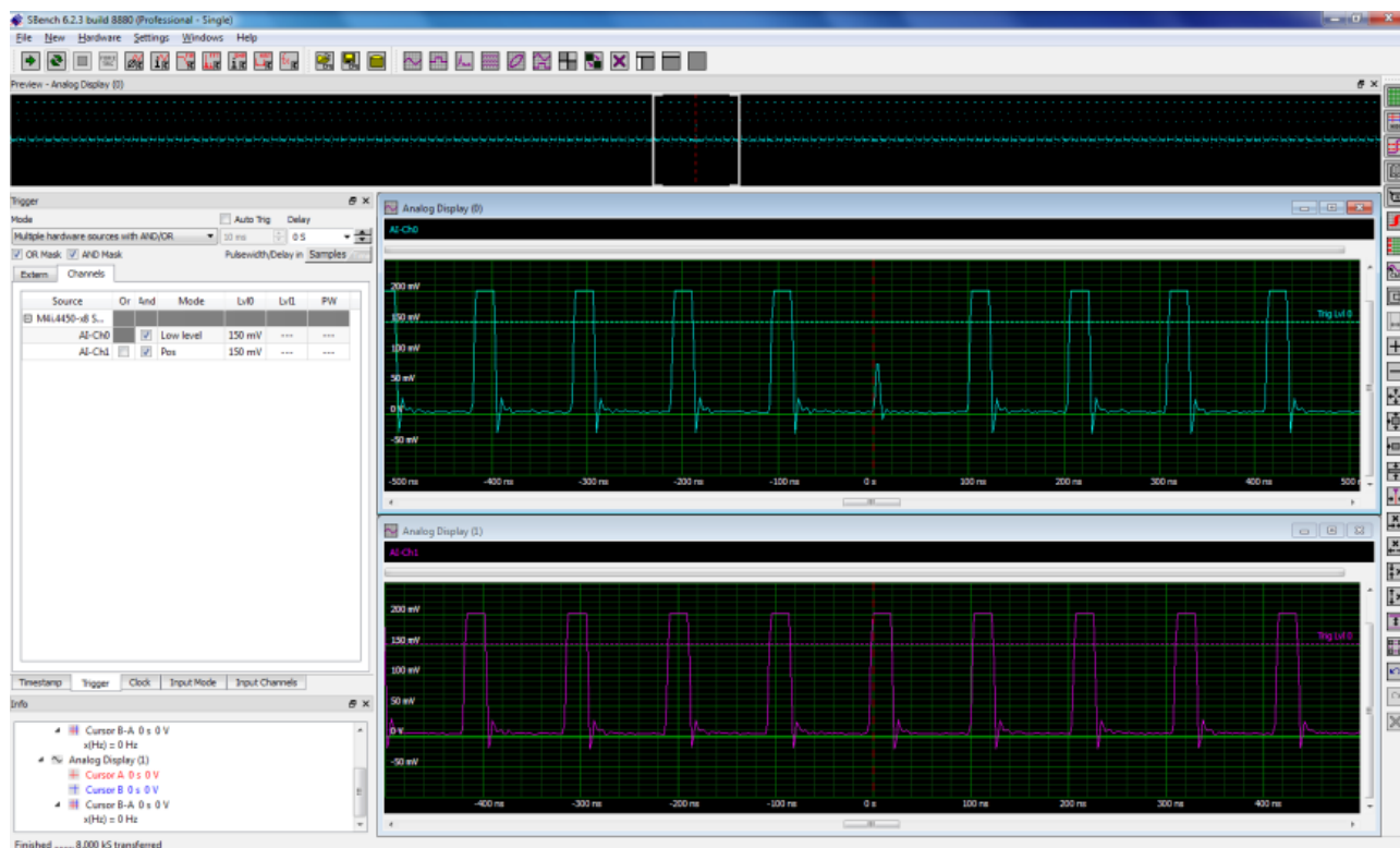
Figure 5 ANDトリガー機能を逆論理要素（Ch0の低レベルモード）で使用する別の例。これは、Ch1のパルス列と比較してCh0で欠落パルスが発生したときにトリガーされます。
