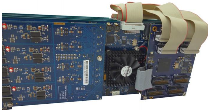
Figure 6 オプションのスターハブモジュールは、4枚のデジタイザの同期を示しています。モジュールは、クロックおよびトリガー信号のスター接続ハブとして機能します。
