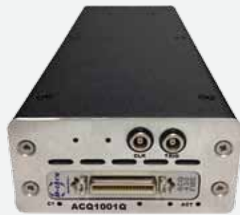
SKY-DAQ-1M-32-AD (1MHz 32ch A/D 搭載)
