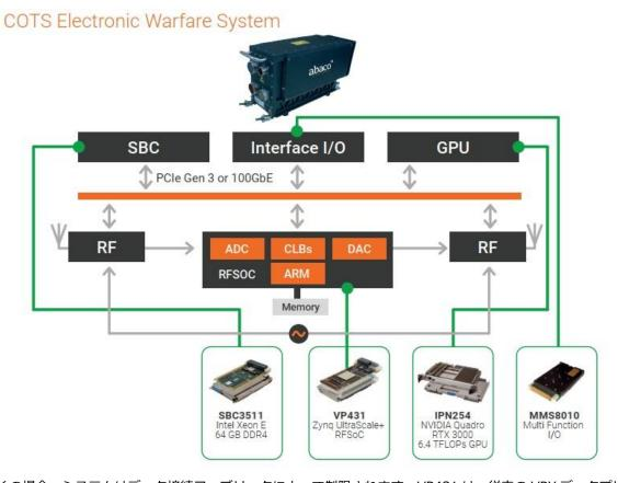
多くの場合、システムはデータ接続ファブリックによって制限されます。VP431 は、従来の VPX データプレーンインターフェイスを備えており、ホストコンピューターへの x4 PCIe Gen3 接続を可能にします。1 サンプルあたり 2 バイトで 5GSPS を超えるレートでサンプリングする 8 つの ADC では、最新の PCIe Gen3 高速データ接続でさえこの速度でのデータ転送に対応できません。
