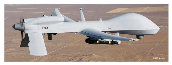
進化する UAV EW プログラムの例は、米陸軍の多機能電子戦-エアラージ(MFEW-AL)です。MFEW-AL は、MQ-1C グレイイーグル UAS に搭載されたエアボーン EW ポッドを使用します。グレイイーグルは、由緒ある General Atmics 製 MQ-1B プレデターUAS の最新バージョンです。MFEW-AL はコマンダーに 2 つの新機能を提供します。1 つは有機的な電子攻撃および妨害機能であり、もう一つは電磁検知および収集機能を提供する電子サポートです。MFEW-AL には、攻撃的な電磁サイバー攻撃を実施するための要件が含まれています。
