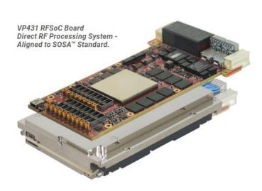
および FMC+サイトを備えた VP889 などの最新の 3U VPX FPGA キャリアの高速トランシーバーに直接低遅延インターフェイスを採用するモジュラーAD/DA ボードを使用できます。FMC+などのメザニン規格を使用すると、ADCカードを簡単にアップグレードできるため、Texas Instruments などの企業の最新の高速 ADC テクノロジで直接 RFサンプリングを行うことができます。
