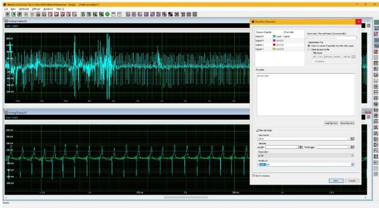
Figure 9: デジタイザによってキャプチャされた32秒の長さのECG波形。波形はSBench6 Functionトレースに転送され、そこでAWGにインポートできます。下のズームトレースは、より馴染みのある洞調律を示しています
