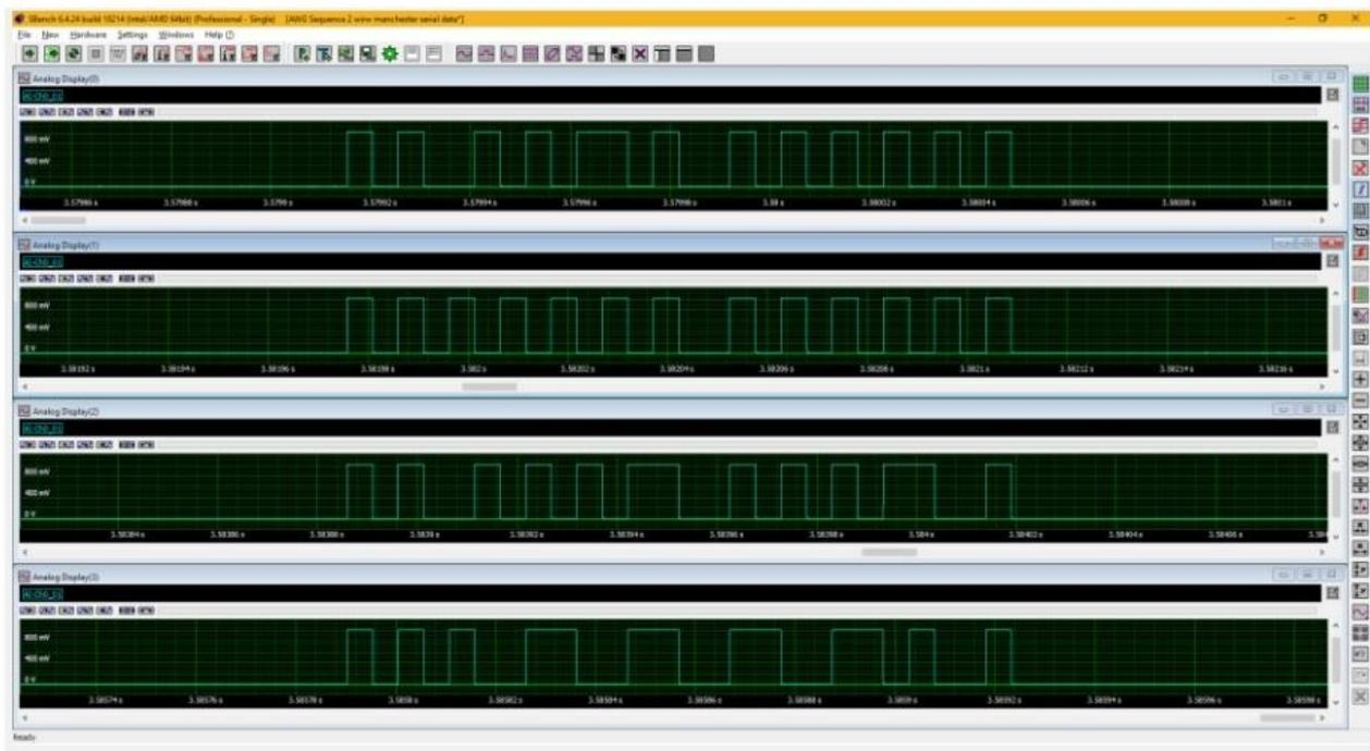
Figure 10: AWG波形メモリに保存されているこれら4つの異なるマンチェスターエンコードシリアルデータパケットのいずれも、前のパケットが出力されている間、コンピュータ制御下で出力するように選択できます。選択したパケットは、現在のバックになるとすぐに出力されます。
