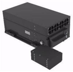
XSR Removable Data Module (RDM) は、すべての Galleon 製データレコーダ・NAS・サーバに卓越した柔軟性を提供します。 現場で工具を必要とせず、簡単に設置できるように設計されており、100,000 回の挿抜サイクルに耐えます。 RDM は業界標準の 2.5 インチソリッドステートストレージ (SSD) モジュールを使用し、モジュールごとに最大 4 つの異なる SSD をサポートします。これにより、ユーザは特定のニーズに最適なミリタリーグレードの超高耐久性または商用グレードの SSD を選択してストレージ機能を最適化し、最大 80TB の使用合計容量を実現できます。 XSR-RDM の迅速な交換は、時間と信頼性が不可欠なミッションクリティカルなアプリケーションに最適です。
