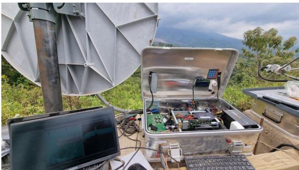
Figure 1 : 電子システムは湿気、雨、ジャングルの野生生物から守るために金属製のボックスに収納されています
