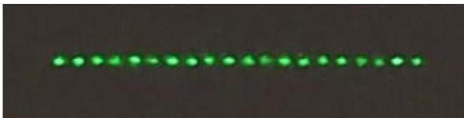
Figure 5. レーザーの1次偏向パターンを示すスクリーンのカメラ画像。レーザーは、20個のキャリアを持つマルチトーン信号が供給されるAODを通過します
